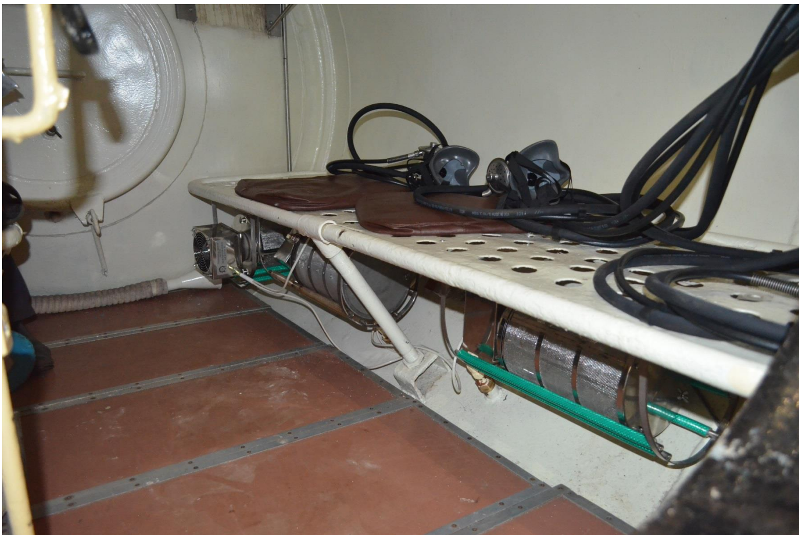
Агрегаты системы очистки газовой среды. Дальний – поглотитель вредных веществ, включая оксид углерода, средний - поглотитель атмосферной влаги, ближний - поглотитель диоксида углерода
