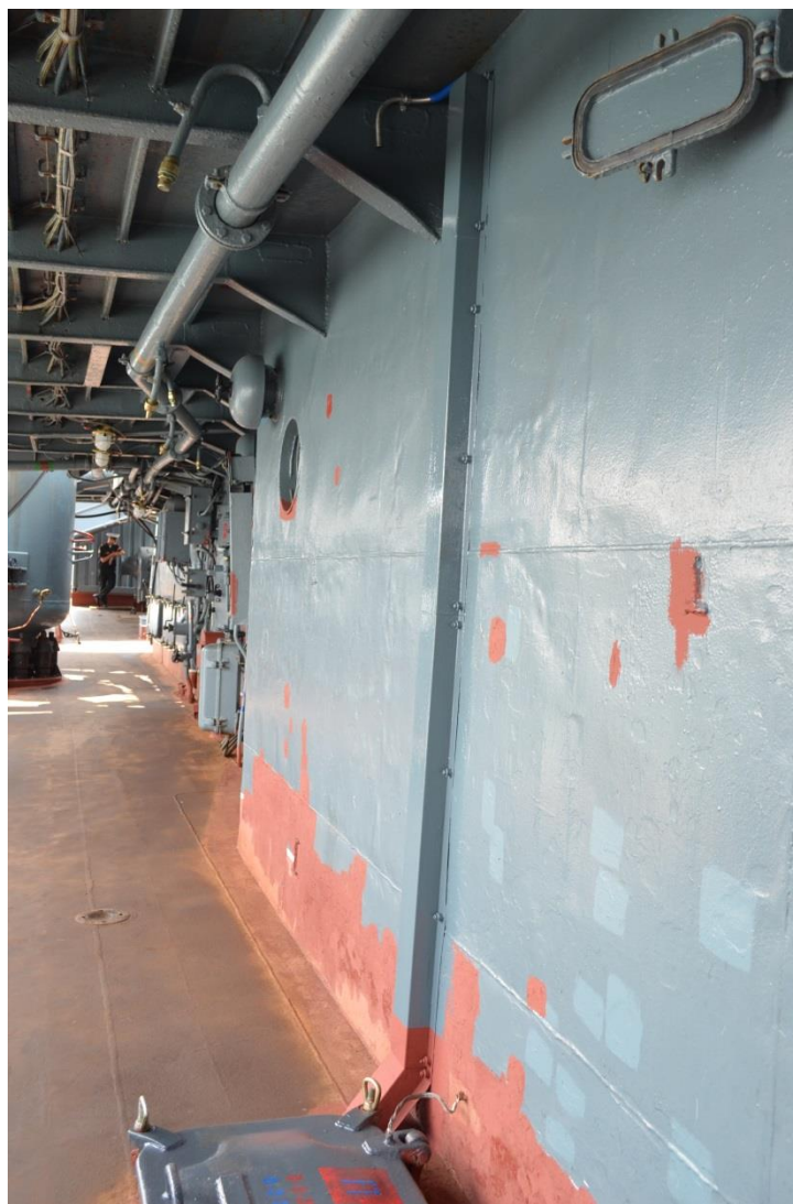
Трубопровод сброса кислорода из кислородной колонки и блока газораспределения
