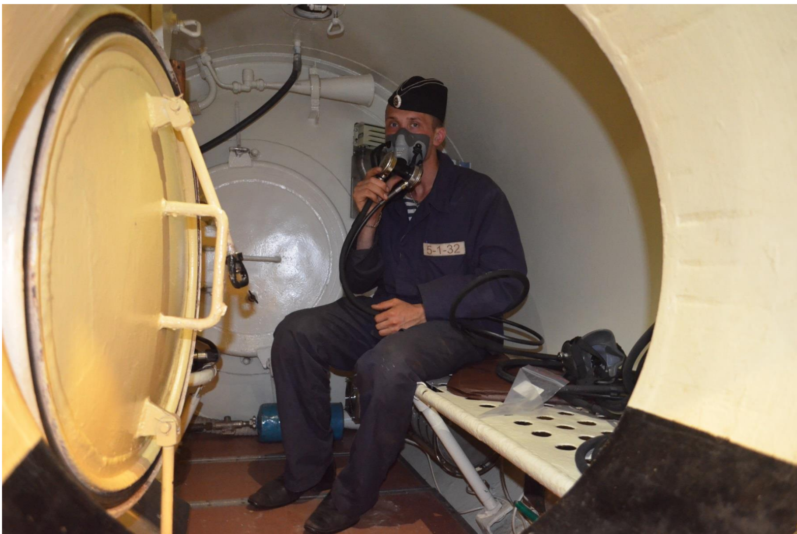
Отсек барокамеры. Работа с маской стационарной дыхательной системы
